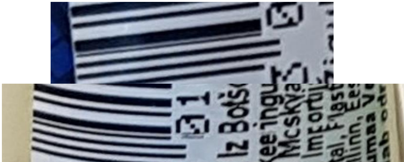
Joonis 38 – Vigaselt trükitud vöötkood, kus üks lisa valge triip takistab vöötkoodi lugemist
