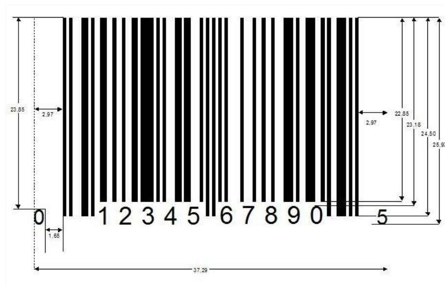
Joonis 25 UPC-A – 100% suurendussuhtega (millimeetrites)
